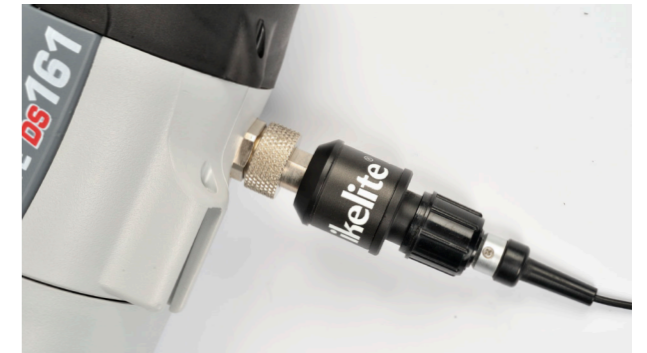
Fiber optic adapter maakt van elektrische flitsers een optische
